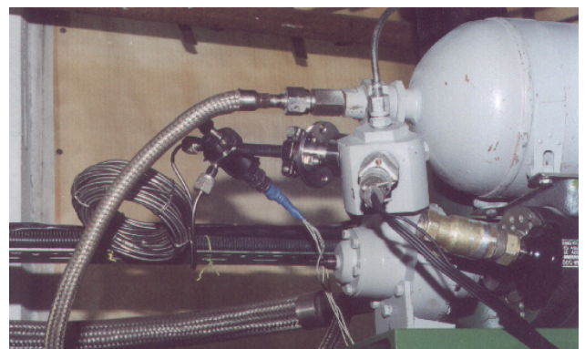
Рис. 2. Общий вид стенда высокого давления. В центре – испытательная камера с датчиком ДД-10 и акустическим зондом П.1422
